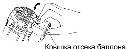
5. Закройте затвор крышки отсека баллона.
