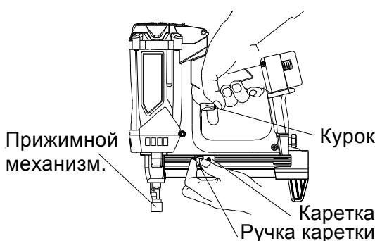
■ ПРОВЕРЬТЕ ИНСТРУМЕНТ БЕЗ ГВОЗДЕЙ
